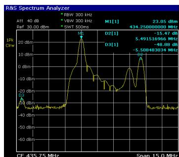
*Output bij 1W (10db demping ingang spectrum analyser)*
